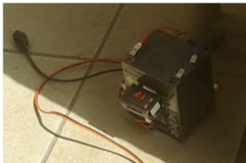
6. ábra. Energiatárolásra alkalmazott savas akkumulátor és a napelem feszültségét mutató digitális kijelző.
